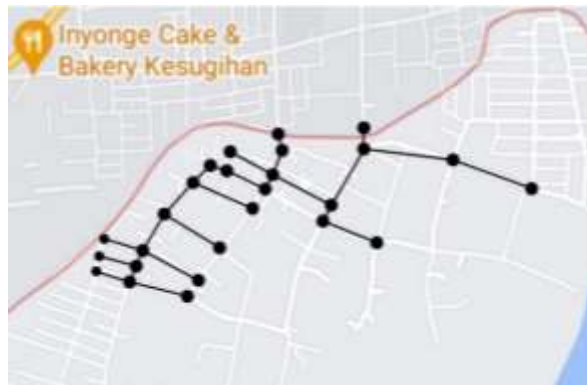
Gambar 13 Jaringan pipa yang sudah terpasang
