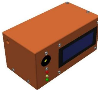
Gambar 3. 5 Perancangan alat deteksi dini kebocoran gas
