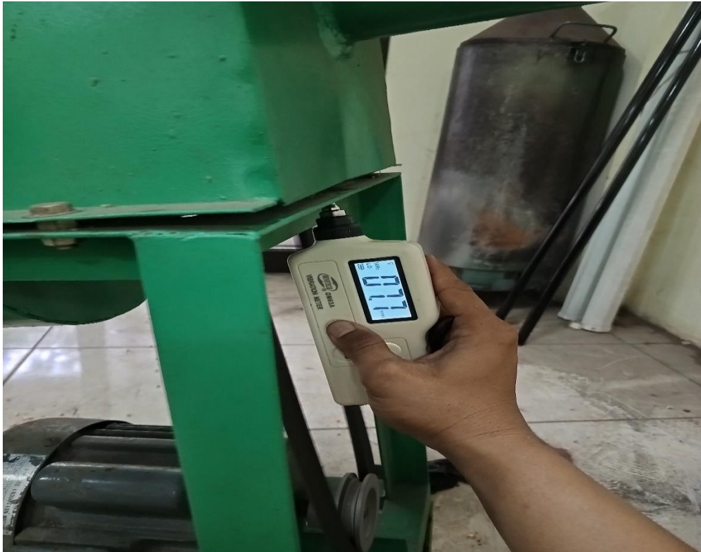
Gambar 25. Pengukuran Getaran Pada Titik Drive End Posisi Vertikal
