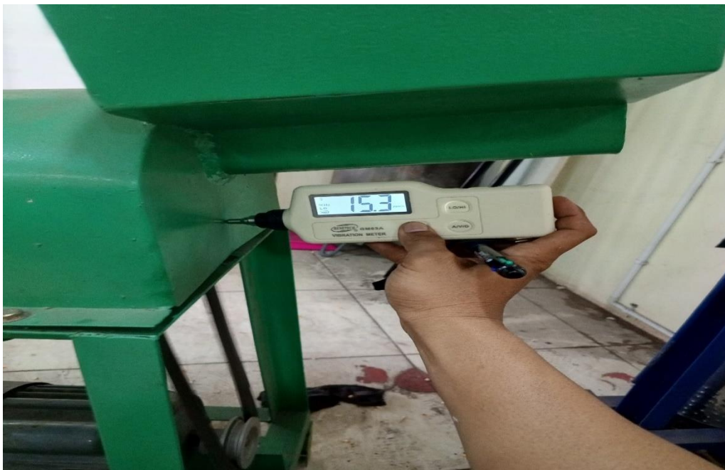
Gambar 26. Pengukuran Getaran Pada Titik Drive end Posisi Axial
