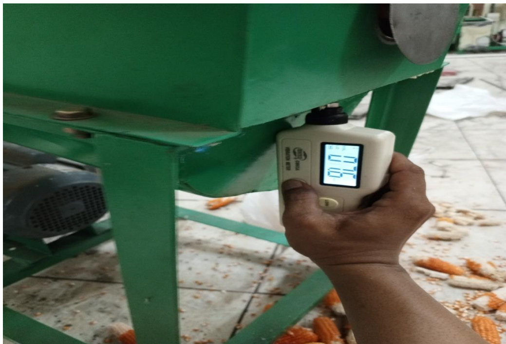
Gambar 28. Pengukuran Getaran Pada Titik Non Drive End Posisi Vertikal
