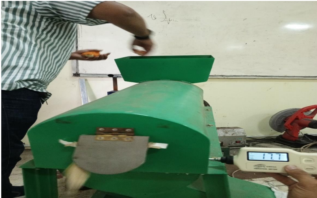
Gambar 27. Pengukuran Getaran Pada Titik Non Drive End Posisi Horizontal
