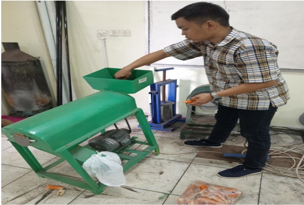
Gambar 23. Proses Pemipilan Jagung Pada Mesin Pemipil Jagung Tipe Silinder Screw
