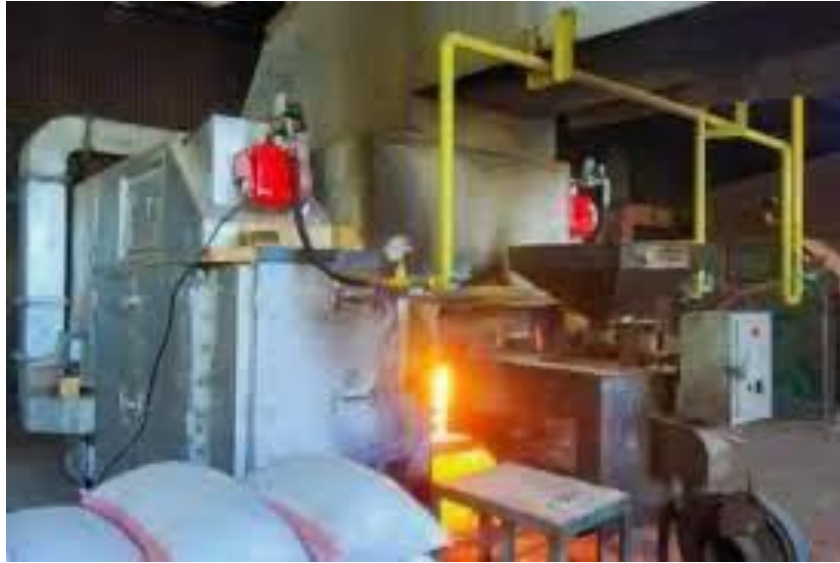
Gambar 4. Penggunaan bahan bakar gas untuk pengeringan
