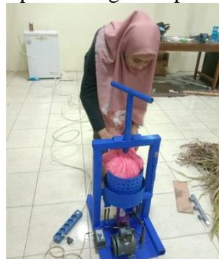
proses penaruhan ampas kelapa ke mesin press hidrolik
