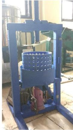
Gambar 4.13. Rangka Mesin
