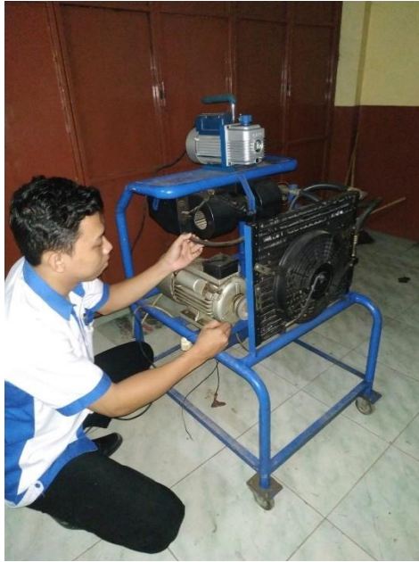
(Gambar sedang melakukan pengecekan pada kompresor)
