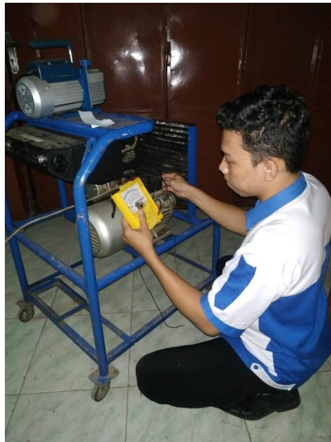
(Gambar sedang melakukan pengecekan menggunakan Multi meter)
