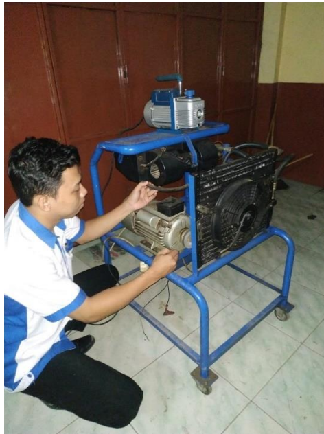
(Gambar sedang melakukan pengecekan pada kompresor)
