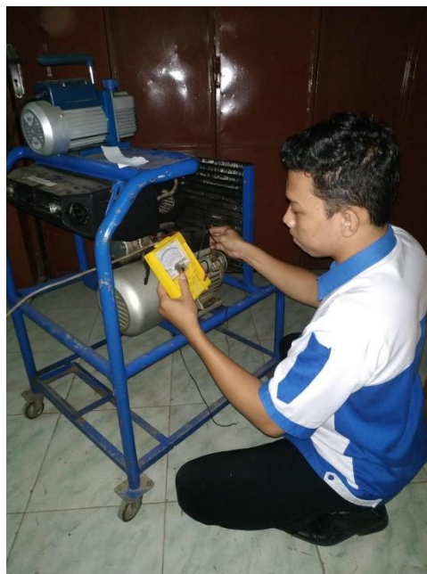
(Gambar sedang melakukan pengecekan menggunakan Multi meter)
