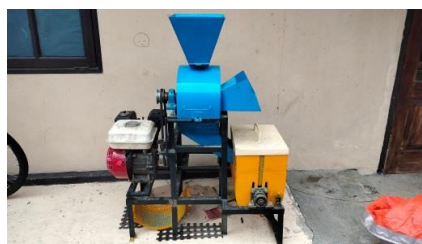
Gambar 3.22 Mesin Pengaduk Pakan Ternak domba.
