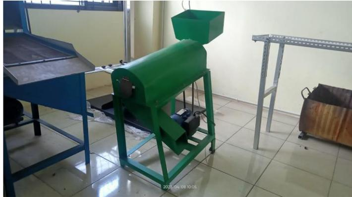
Gambar 4. 3 hasil modifikasi mesin pemipil jagung type silinder screw
