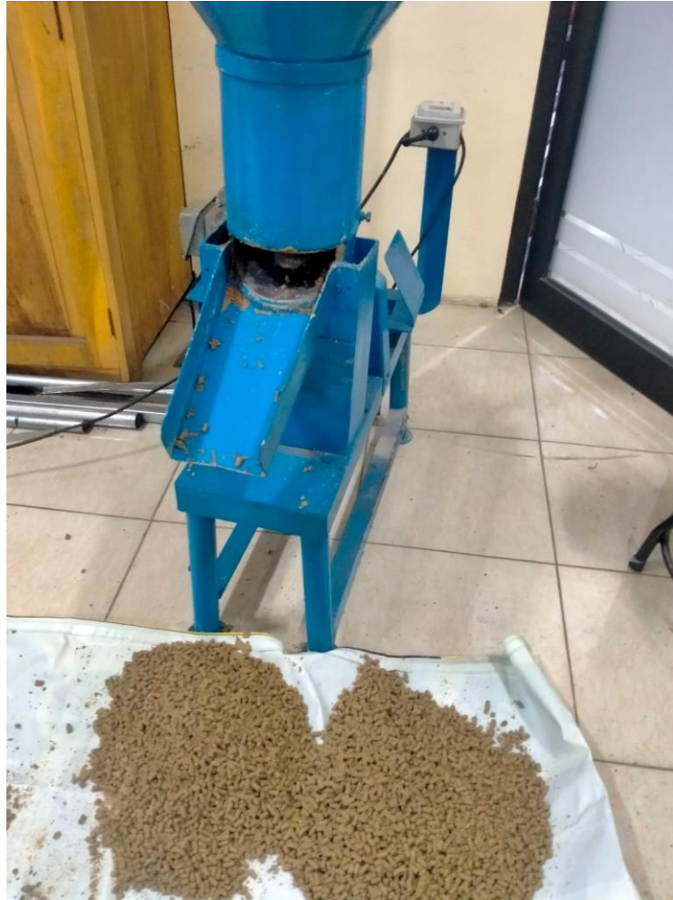
Gambar 3. Percobaan mesin pencetak pelet
