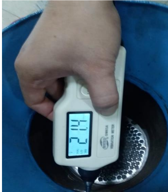
Gambar 9. Pengukuran Getaran di Roller
