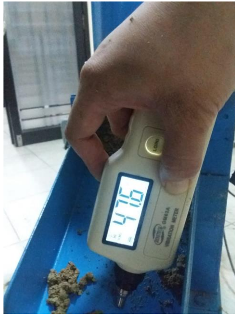
Gambar 12. Pengukuran Getaran Menggunakan Beban
