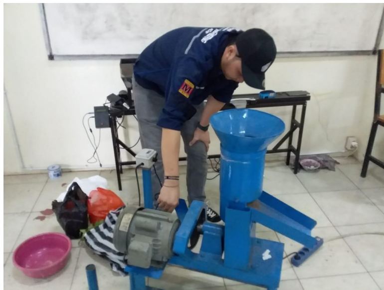
Gambar 13. Pengukuran Getaran Menggunakan Beban Pada Dudukan Motor
