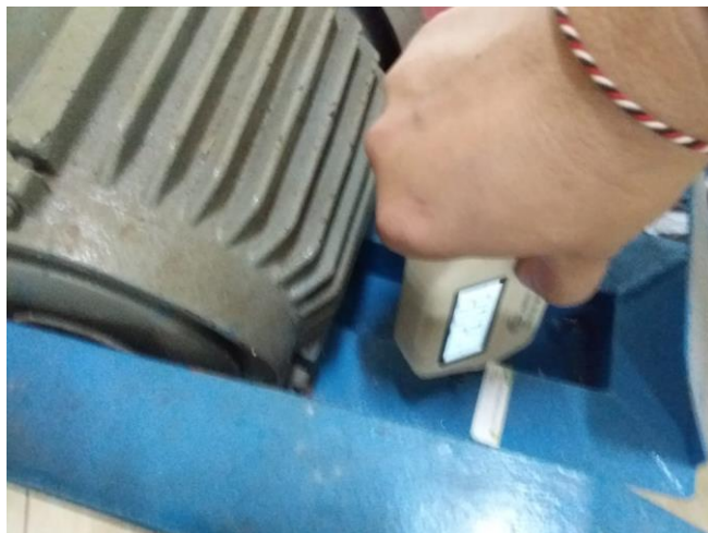
Gambar 10. Pengukuran Getaran Tanpa Beban Pada Motor Listrik
