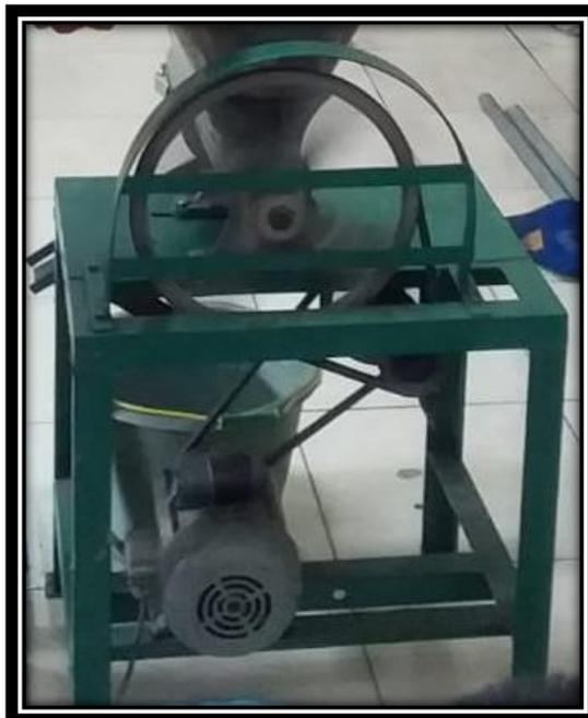
Gambar 14. Pulley dan V belt
