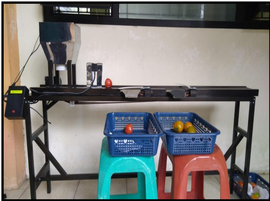
Gambar 18. Prototype Mesin Sortasi Tomat Berbasis Arduino
