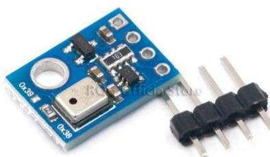
Gambar 7 Sensor AHT10
