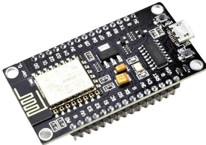
Spesifikasi NodeMCU ESP8266
