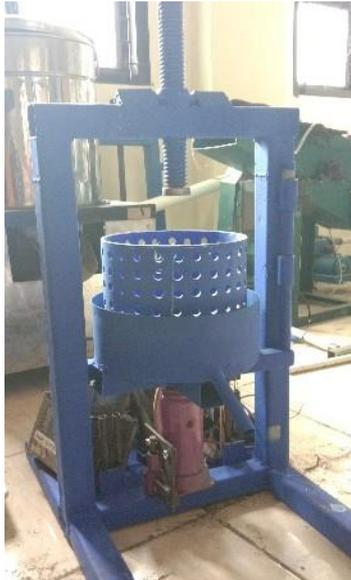
Gambar 4. Mesin pemeras santan sistem hidrolis (Indah Dwi S.)
