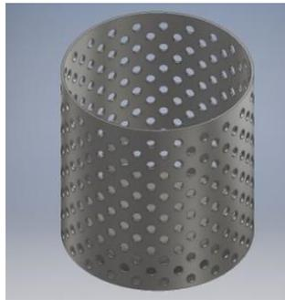
Gambar 7. Tabung Pengepresan (Indah Dwi S. 2022)
