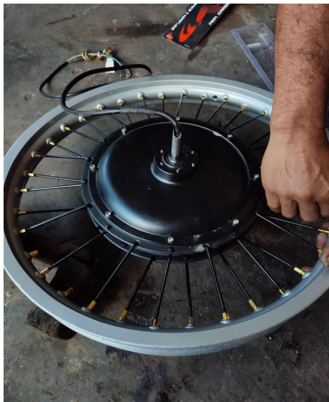
Gambar 2 Pemasangan BLDC Pada Velg
