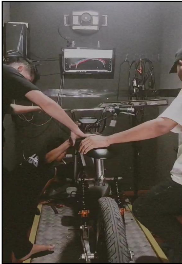
Gambar 4 Pemasangan Sepeda Listrik Vanjaril Pada Dynotest
