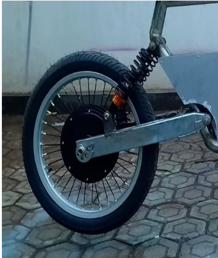
Gambar 1 Pemasangan BLDC Pada Arm
