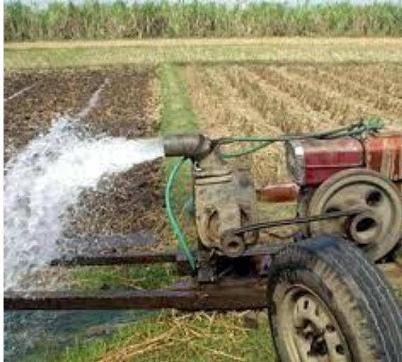
Gambar 1. Pompa air berbahan bakar minyak untuk irigasi (Direktorat Jenderal Prasarana Dan Sarana Pertanian Kementerian Pertanian, 2019)
