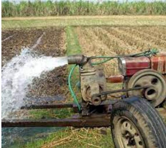
Gambar 1. Pompa air berbahan bakar minyak untuk irigasi
