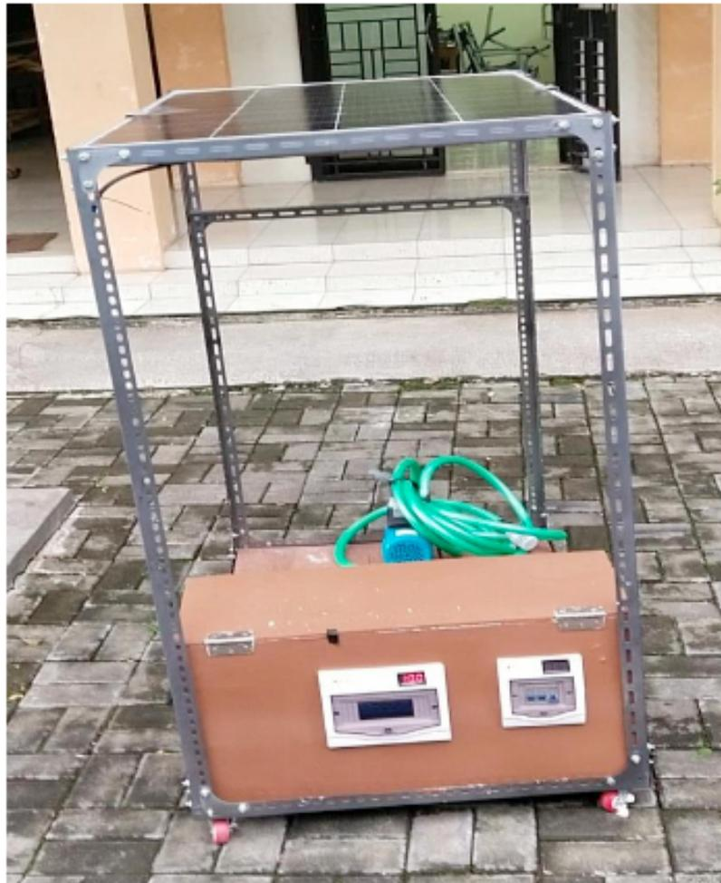
Gambar 8. Pompa air tenaga surya dengan *switch remote control*
