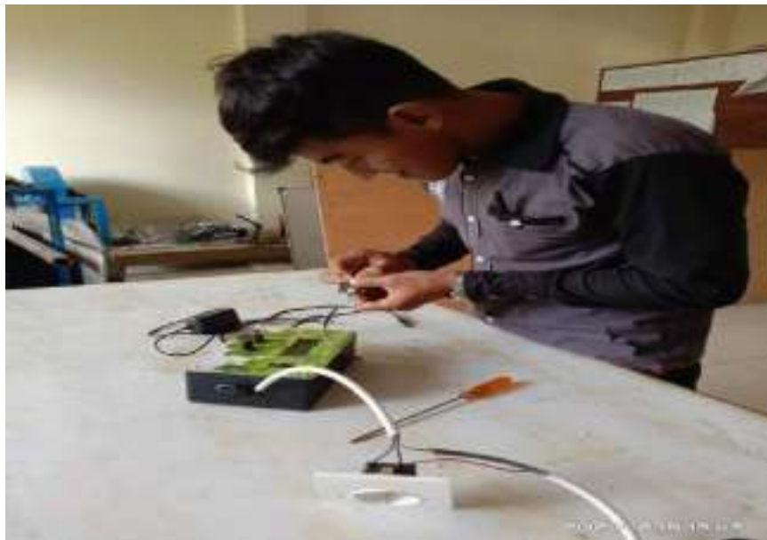
Gambar 4.11. Perakitan Sensor TDS
