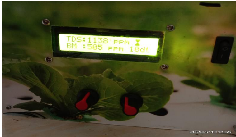
Gambar 4.13. Pengukuran Sensor TDS nutrisi
