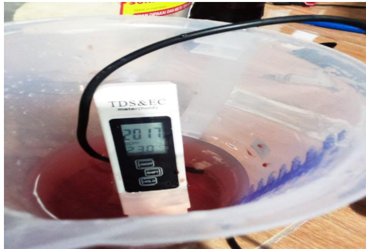
Gambar 4.15. Pengukuran air nutrisi menggunakan TDS Meter manual
