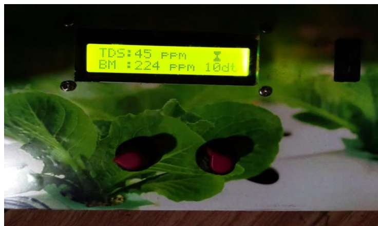
Gambar 4.14. Pengukuran Sensor TDS air biasa
