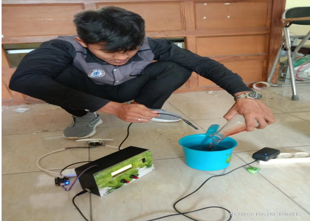
Gambar 7. Pengecekan sensor terhadap air nutrisi
