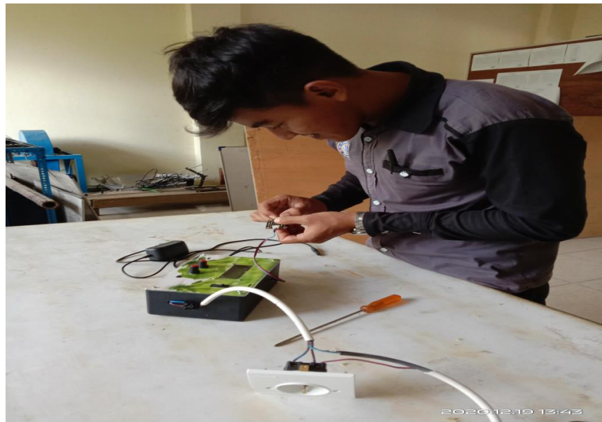
Gambar 4.11. Perakitan Sensor TDS
