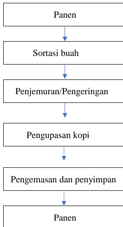
Gambar 1 Tahapan pasca panen kopi secara kering
