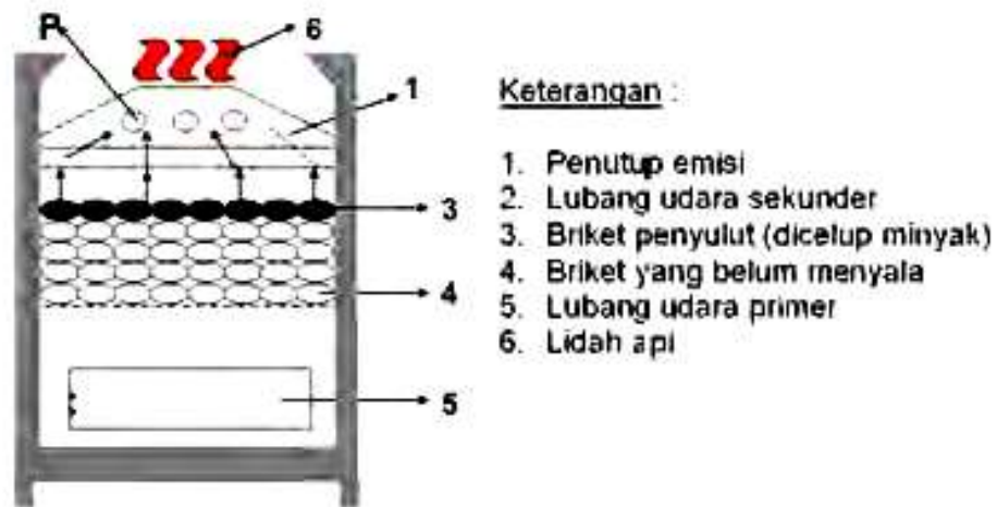
Gambar 2. Skema tungku briket
