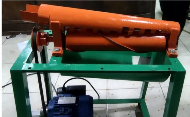
Gambar 4. 3 hasil modifikasi mesin pemipil jagung type silinder screw
