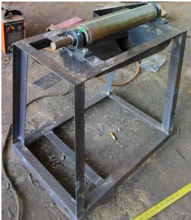
Gambar 4. 2 Rangka Mesin Pemipil Jagung Type Silinder Screw
