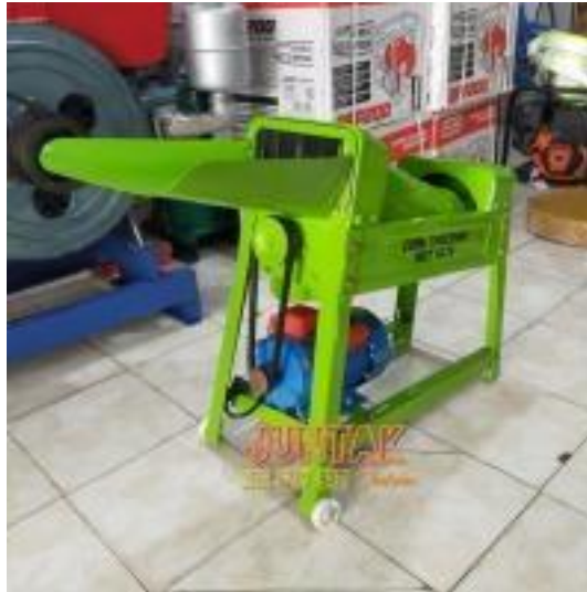
Gambar 2. 2 Mesin pemipil jagung Type MCT 18-75
