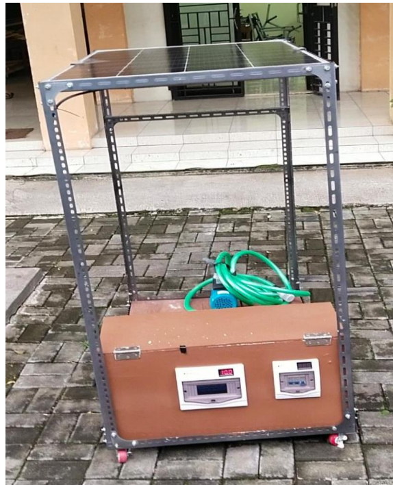
Gambar 4.12 Pompa Air Tenaga Surya Dengan Switch Remote Control
