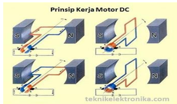
Gambar 2.6 .Cara bekerja unit motor Arus searah
