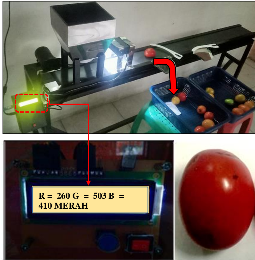
Gambar 4.6 .Percobaan alat dengan menggunakan buah Tomat berwarna Merah
