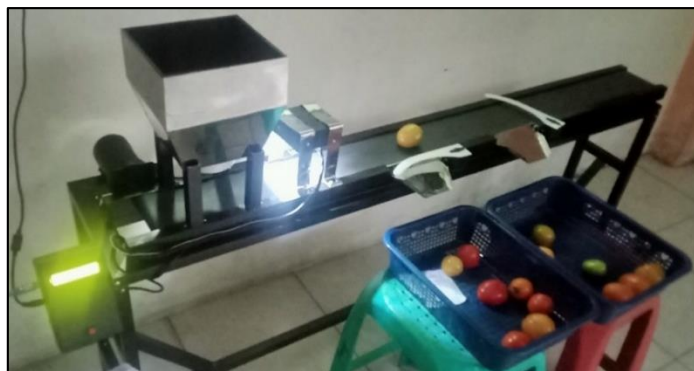
Gambar 4.1. Desain beserta Implementasi Kerangka untuk Alat pemisah/sortir
