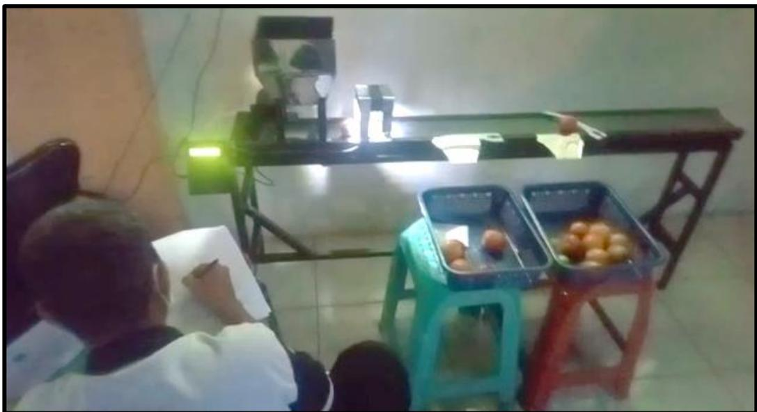
**Gambar keseluruhan rangkaian prototype penyortir tomat menggunakan sensor warna berbasis arduino**
