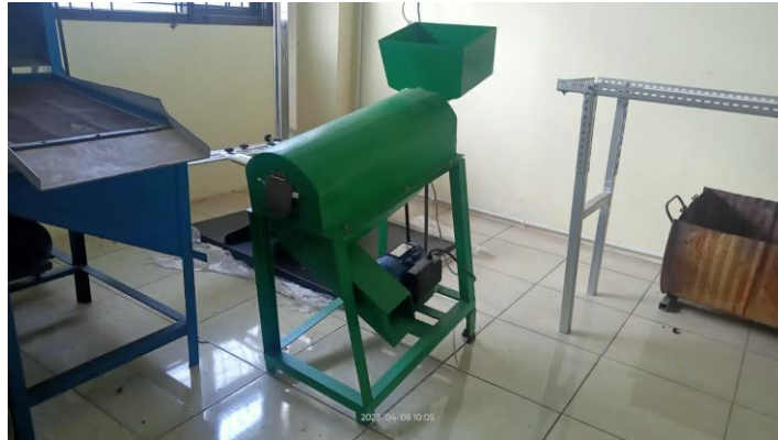
Gambar 4. 3 hasil modifikasi mesin pemipil jagung type silinder screw
