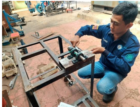
Gambar 2 proses produksi mesin dan pemasangan komponen mesin
