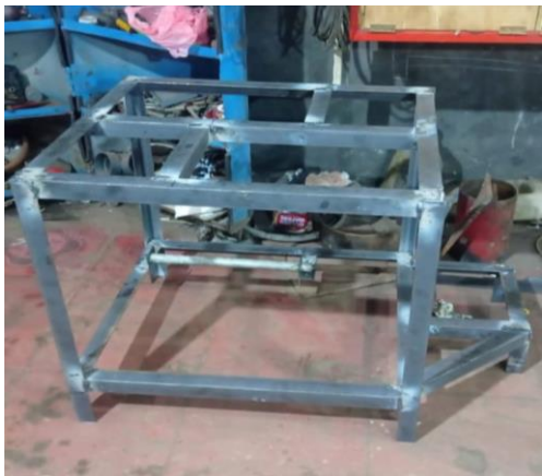
Gambar 3 rangka mesin dan mesin pengerol kawat pemberat jala
