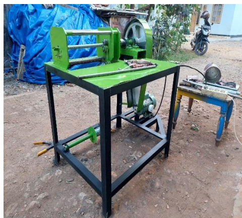
Gambar 3 rangka mesin dan mesin pengerol kawat pemberat jala
